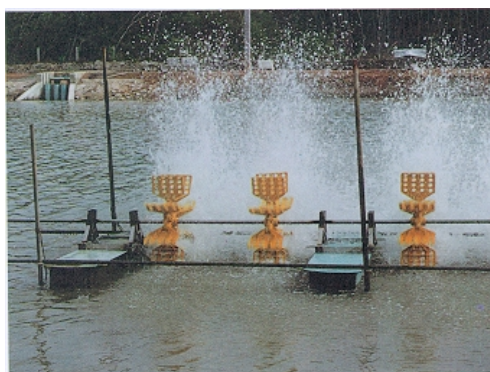
ภาพที่ 8 แสดงเครื่องช่วยเพิ่มอากาศในบ่อเลี้ยงกุ้ง
